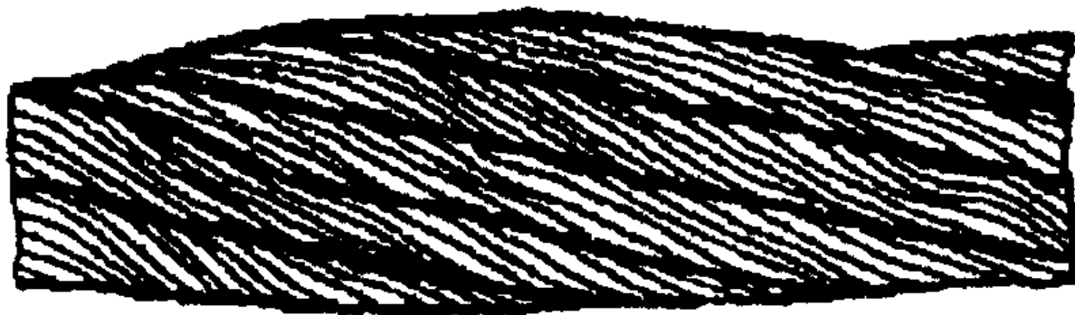
Рисунок 13. Местное увеличение диаметра каната.
