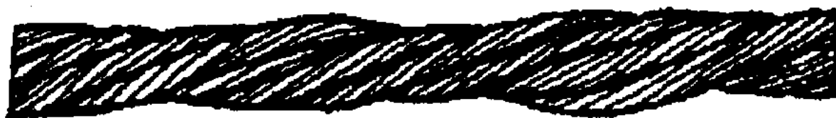
Рисунок 9. Местное уменьшение диаметра каната на месте разрушения органического сердечника.
